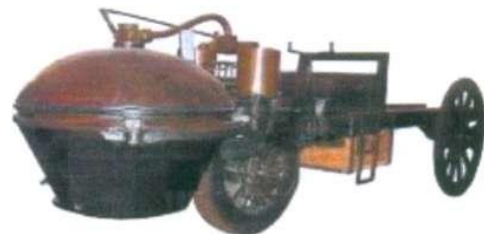
Паровая тележка Кюньо (1771), вторая модификация
