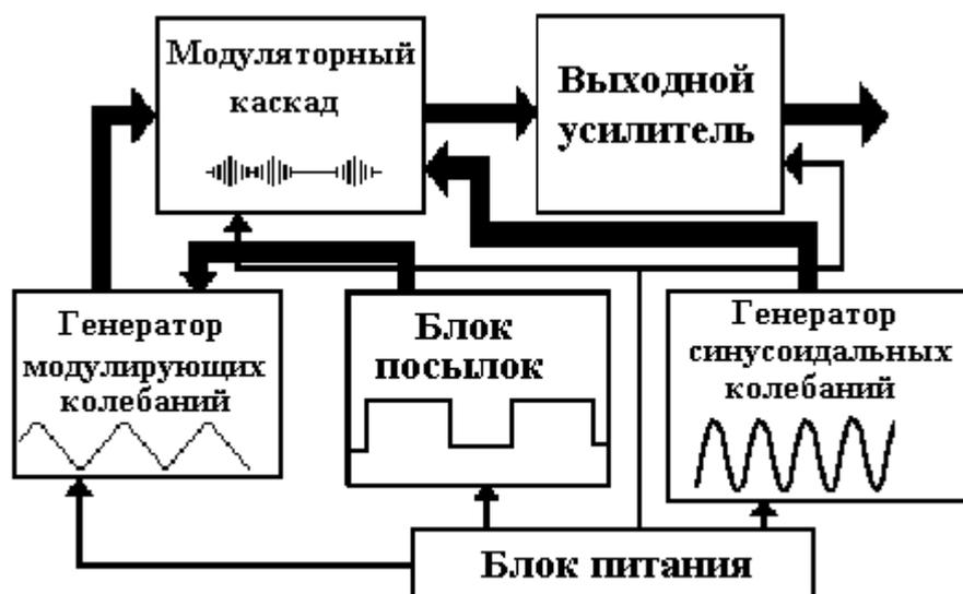
Рис. 4. Блок-схема аппарата "Амплипульс" (тонкими линиями показаны цепи питания блоков, жирными – пути передачи и преобразования основного сигнала, на блоках указан вид вырабатываемых ими сигналов).
