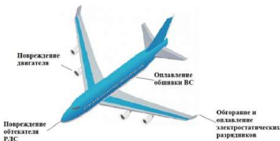
Рисунок 2 – Места повреждений самолетов в результате попадания молнии
